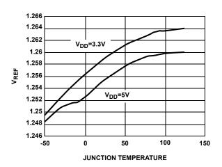
FIGURE 3. V<sub>REF</sub> vs TEMPERATURE
