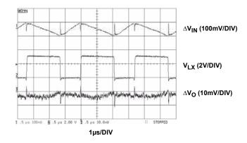
FIGURE 13. STEADY-STATE OPERATION
