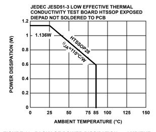
FIGURE 10. PACKAGE POWER DISSIPATION VS AMBIENT TEMPERATURE
