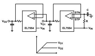
FIGURE 23. LINEAR START-UP TRACKING
