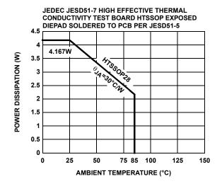
FIGURE 11. PACKAGE POWER DISSIPATION vs AMBIENT TEMPERATURE
