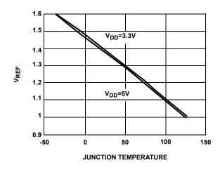
FIGURE 4. V<sub>REF</sub> vs TEMPERATURE
