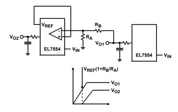
FIGURE 24. OFFSET START-UP TRACKING
