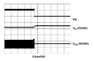
FIGURE 17. OVER-VOLTAGE SHUT-DOWN
